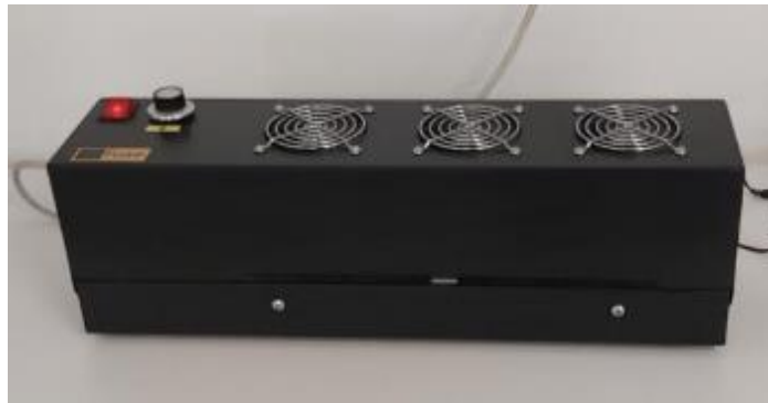
איור 11 - מכשיר הטבעה - מטביע מתאר של ציור להבלטה עבור ילדים לקויי ראייה
